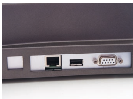
PORTO LADEN: Um Porto zu laden, genügt eine Verbindung über die LAN-Schnittstelle. Über den USB-Port lässt sich eine zusätzliche Waage anschließen.
